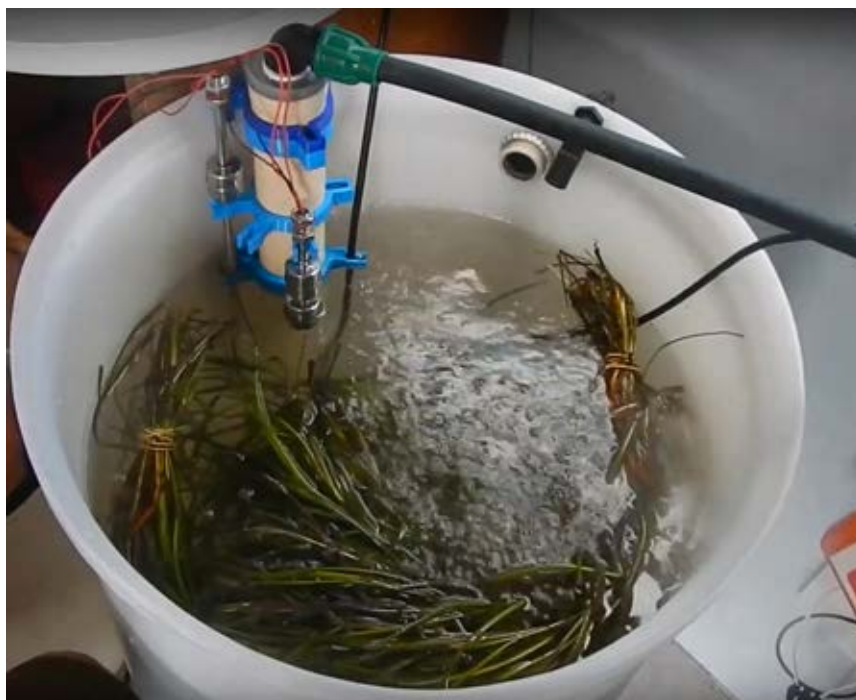
Figure 10 : Bac de 100L du local n°1 (caravane le Nautille). On y voit des tiges reproductives (groupées par 25) et les seuils de niveau. Les tiges viennent d'être introduites.
