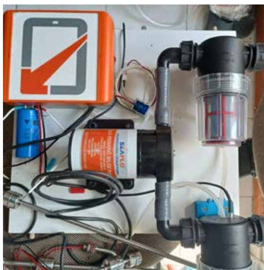
Figure 13 : système de renouvellement de l'eau des bacs
