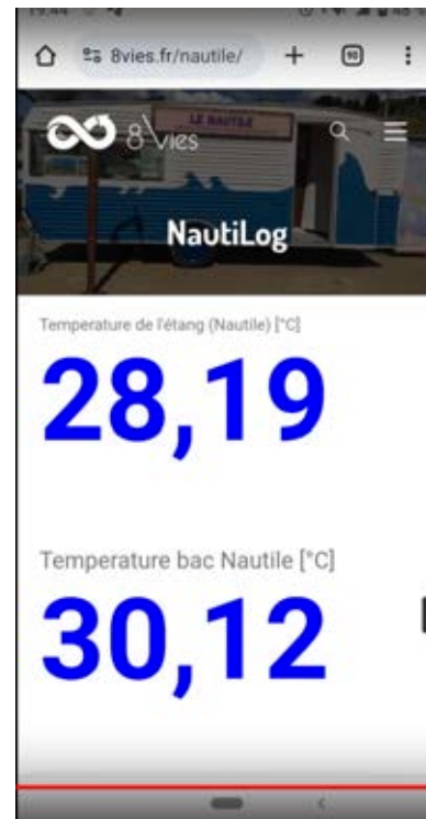
Figure 14 : image de l'application utilisée par le projet. On y voit en temps réel les deux températures les plus importantes : la température du bac et celle de l'étang (ici, pour le Nautile)
